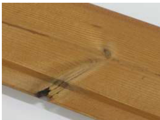
Neviditelné vady po instalaci jsou povoleny.
