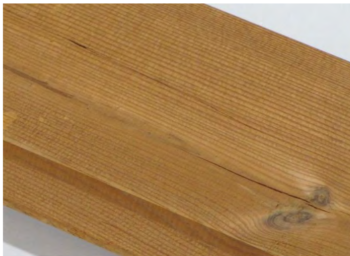
Trhliny na lícnej strane do dĺžky 200 mm po výrobe povolené
